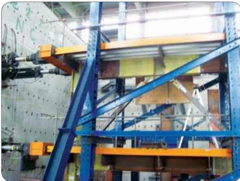
<그림 3> 반력시스템 활용 내진실험
