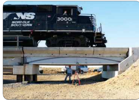
〈그림 5〉 Live Load Tests on Prototype HCB Bridge
